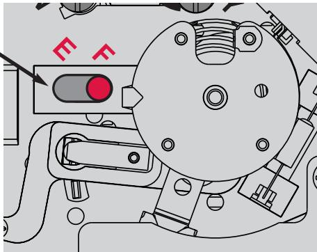
**E** : Amenez le commutateur dans cette position dans le cas d'une thermopompe ou d'une installation de chauffage électrique. (Cette configuration est pour les installations qui permettent au thermostat de commander le ventilateur pendant la demande de chauffage si un fil de ventilateur est raccordé à la borne G.)
