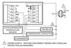
A FACTORY INSTALLED JUMPER.
